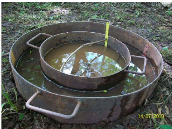
Fotografía 4.1 – Detalle de la instalación de los anillos para un prueba de infiltración.
