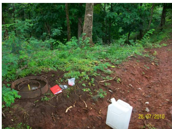
Fotografía 5.1 – Prueba de infiltración A5. Suelos residuales sobre basaltos de la meseta estructural.
