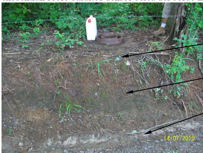
Fotografía 4.3 – Prueba de infiltración D3. Suelo delgado sobre basalto fracturado.
