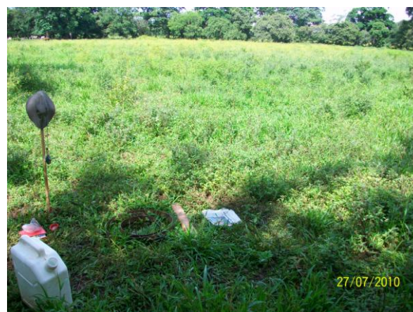
Fotografía 5.2 – Prueba de infiltración A7. Suelos sobre la unidad de relleno aluvial.
