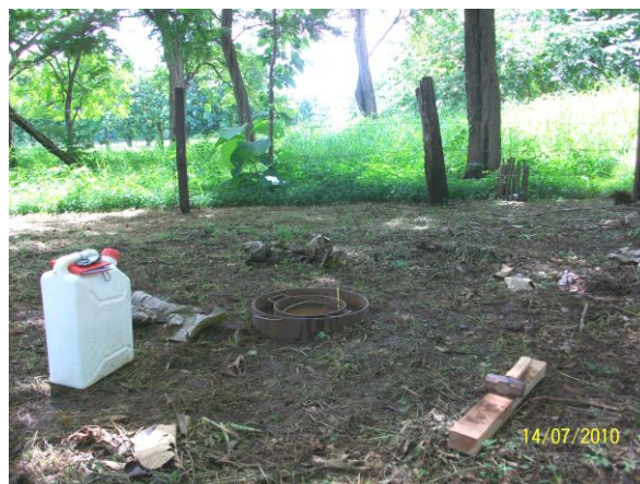
Fotografía 4.2 – Prueba de infiltración D1, área de llanura aluvial.
