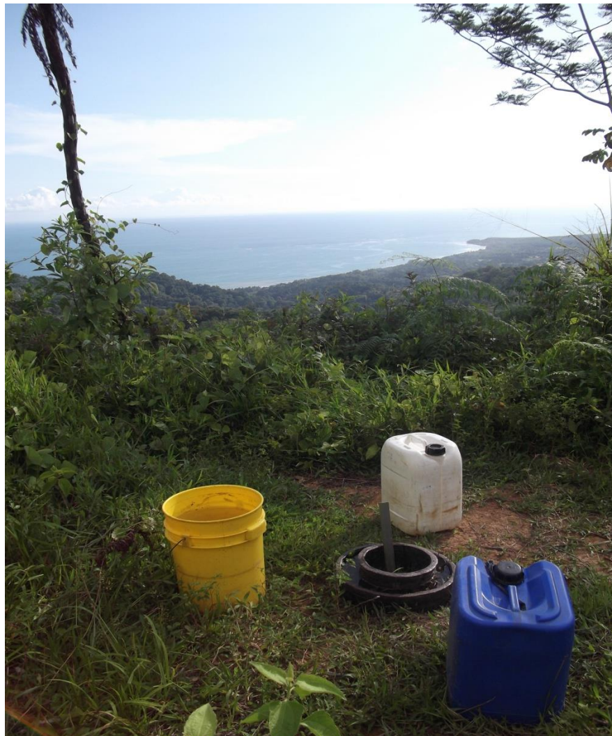
Figura 77: Prueba de infiltración IB-4, realizada en la divisoria de aguas de Fila Tigre.
