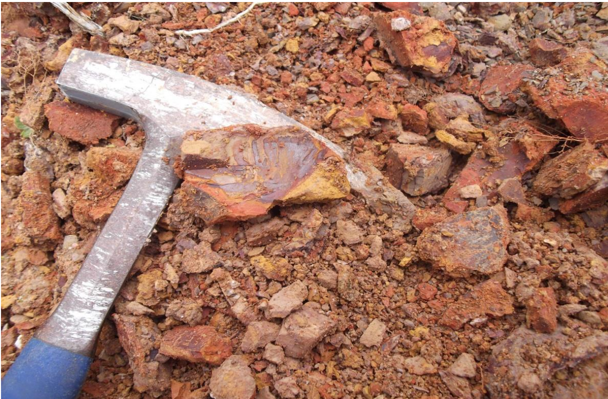
Figura 19: Lutita alterada con aparente presencia de minerales asociados a efectos de oxidación.
