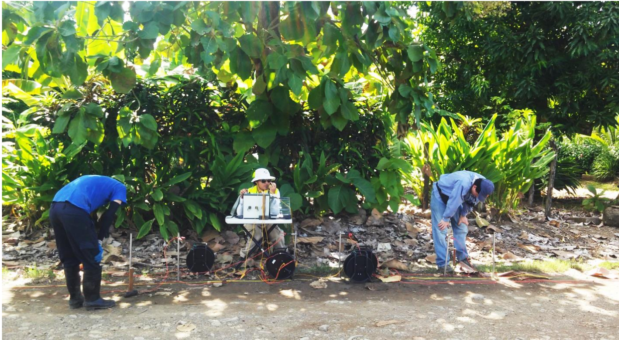
Figura 31: Disposición del equipo geoelectrico para la realización de un SEV en las cercanías del Parque Nacional Marino Ballena.
