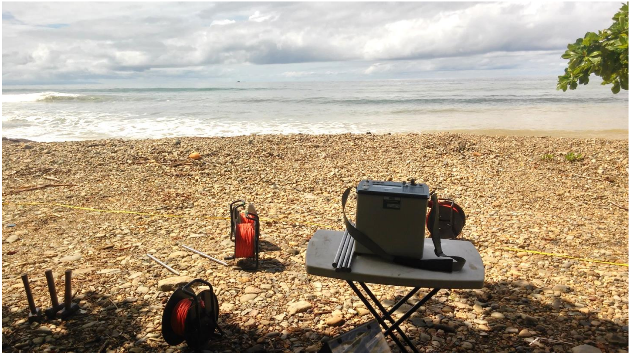
Figura 34: Sondeo Eléctrico Vertical SEVB-12 realizado en playa Hermosa de Uvita.
