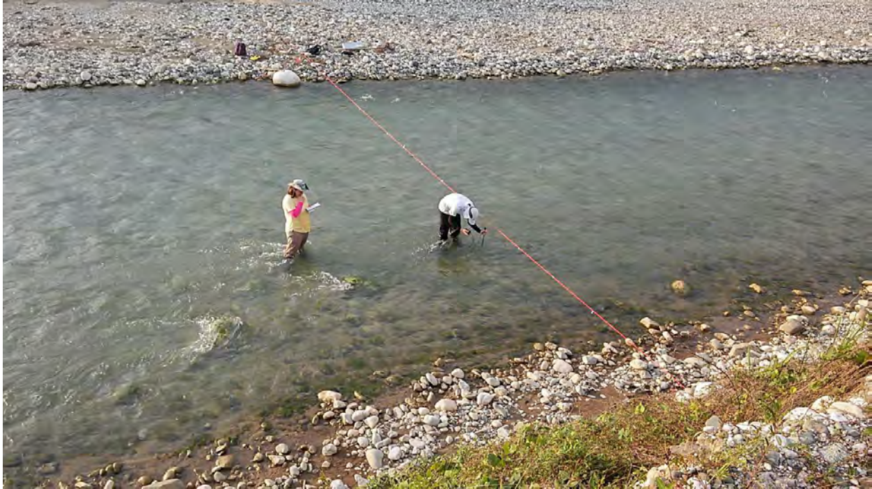
Figura 37: Aforo realizado en una sección del Río Claro. Fuente: Elaboración propia.
