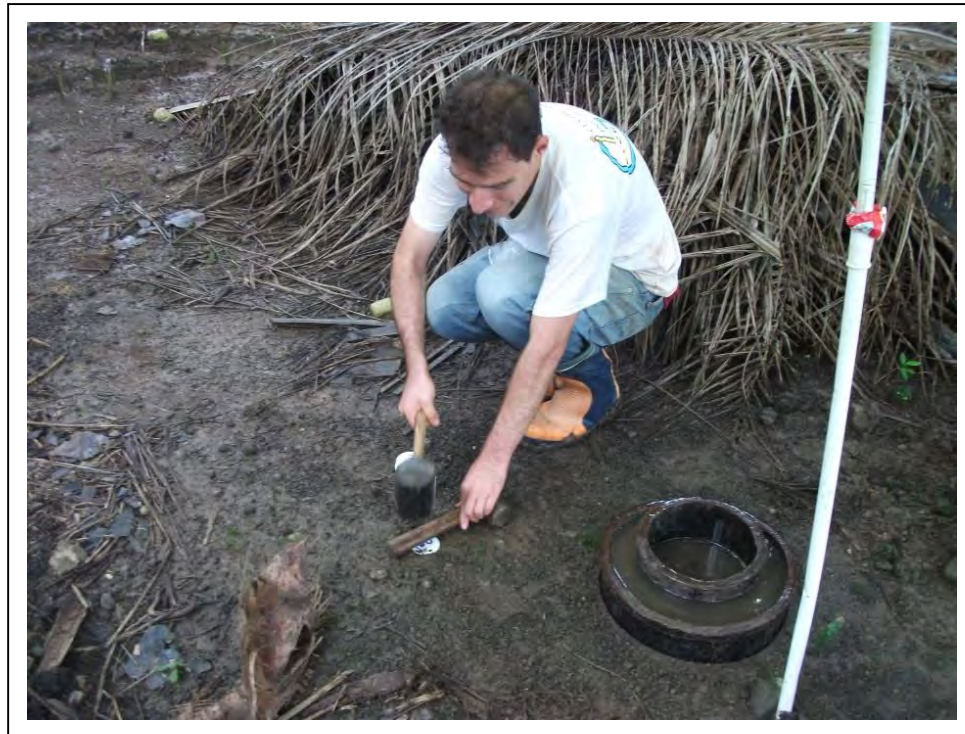
Figura 47: Proceso de toma de muestras de suelo. Fuente: Elaboración propia.
