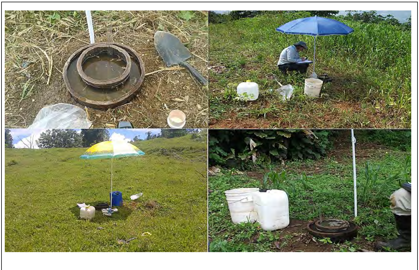
Figura 44: Pruebas de infiltración de campo realizadas mediante la metodología del doble anillo. Fuente: Elaboración propia.
