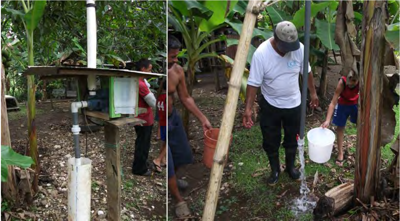
Figura 35: Medición de caudal en pozo artesanal. Fuente: Elaboración propia.
